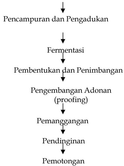
Gambar 1. Bagian Proses Pembuatan Roti Tawar.
