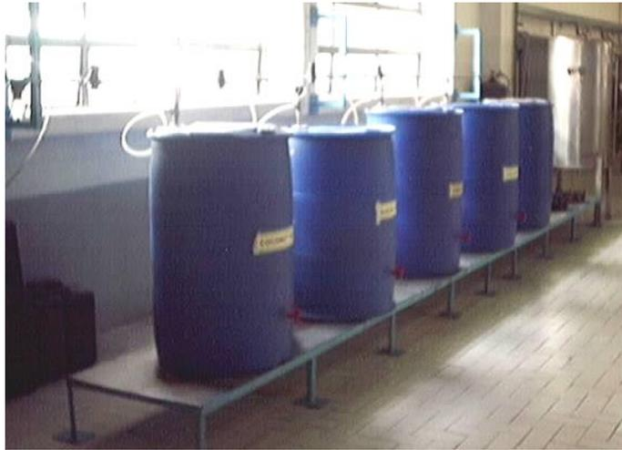
Gambar 5. Contoh Acetator 5 drum kapasitas produksi 1000 liter
